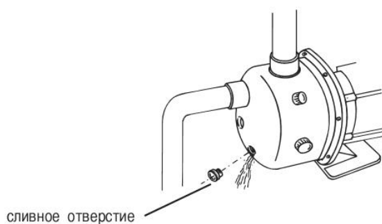
Рис. 7 Осушение рабочей полости насоса
